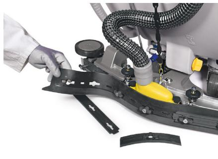
La sostituzione e la rotazione delle gomme del tergilavaggio si realizzano in pochi istanti e non è necessario l'utilizzo di utensili
