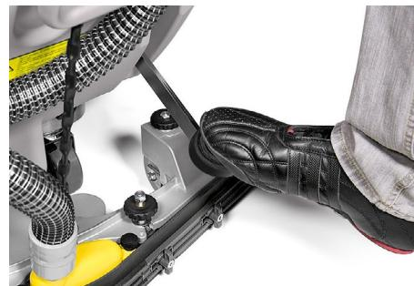
La catena di abbassamento del tergipavimento è robusta, realizzata in acciaio, e dotata di una maniglia ergonomica in pressofusione di alluminio
