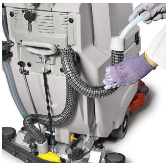
Per assicurare un'asciugatura sempre perfetta è fondamentale eseguire al termine di ogni intervento la pulizia del tubo aspirazione e delle gomme del tergilavaggio. Quest'ultimo si può sollevare per permettere di accedere alle gomme con facilità e pulirle rapidamente
