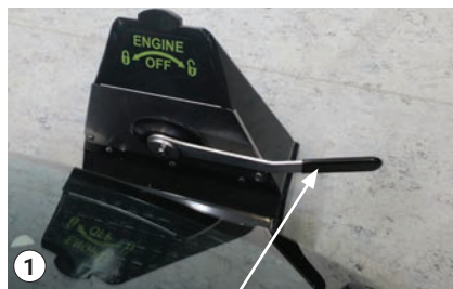
Uchwyt blokujący - Położenie otwarcia
