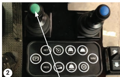
Lewy Joystick - Przechylanie/opuszczanie kosiarki.
