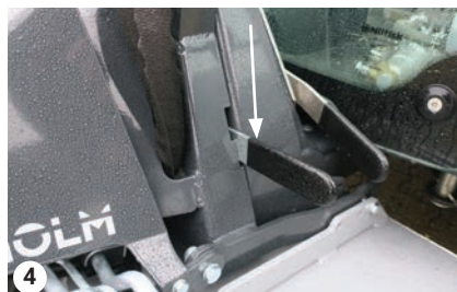
Blokada przechylenia - Uchwyt w dolnym położeniu
