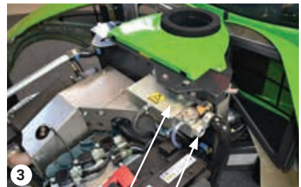
Zbiornik wyrównawczy – kontrola płynu chłodzącego
