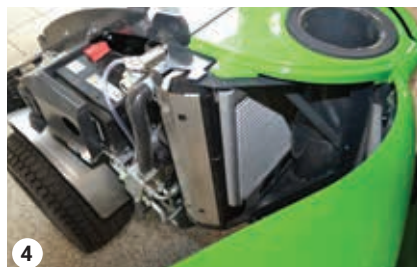
Wyczyścić chłodnicę sprężonym powietrzem
