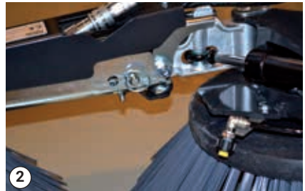
2 Zakładanie przewodów hydraulicznych + przewodów wodnych na szczotkę bocznej
