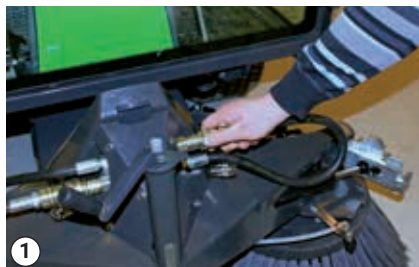
Odczep przewód hydrauliczny
