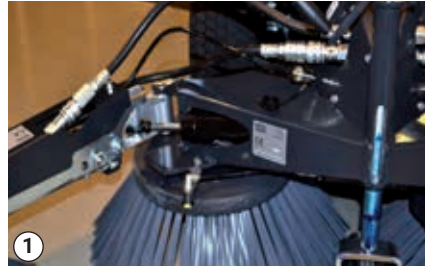
1 Zakładanie przewodów hydraulicznych + przewodów wodnych na ramie A
