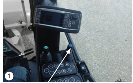
Wychylenie szczotki w lewo i w prawo.
