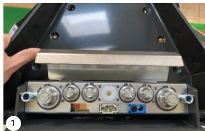
„Oczyszczyć złącza szmatką”
