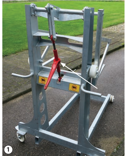
Przełącznik położenia otwartego/zamkniętego mechanizmu zapadkowego ramy.
